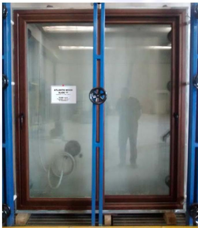
Foto 2: Foto del campione durante la prova di tenuta all'acqua
