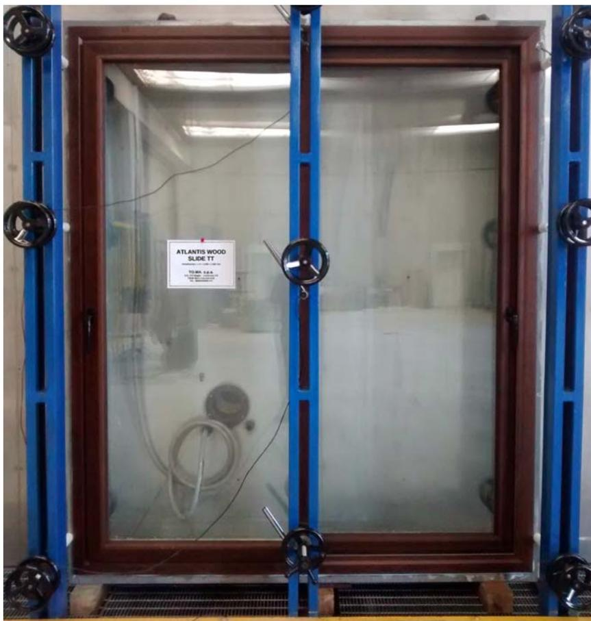
Foto 3: Campione durante la prova di resistenza al carico del vento (prova di deformazione)
